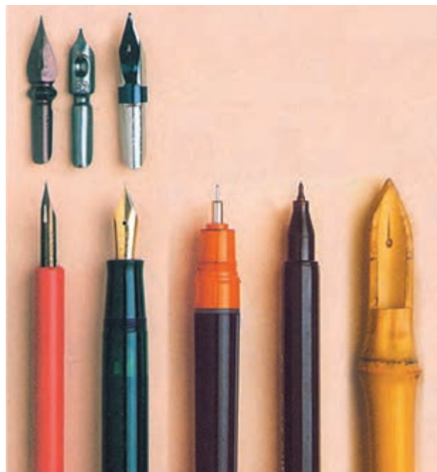
تصویر ۲-۲۴- از راست به چپ: قلم نی، روان‌نویس، راپیدوگراف، خودنویس، قلم آهنی (با چند نوع نوک اضافه که می‌توان بر بدنه آن سوار کرد).
